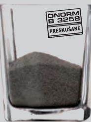
Normálna dlažba Zvetranie až do 1 000 g/m 2 podľa normy ÖNORM
